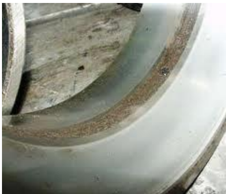
Рис. 1.2 – Окислительный износ внутренней беговой дорожки
