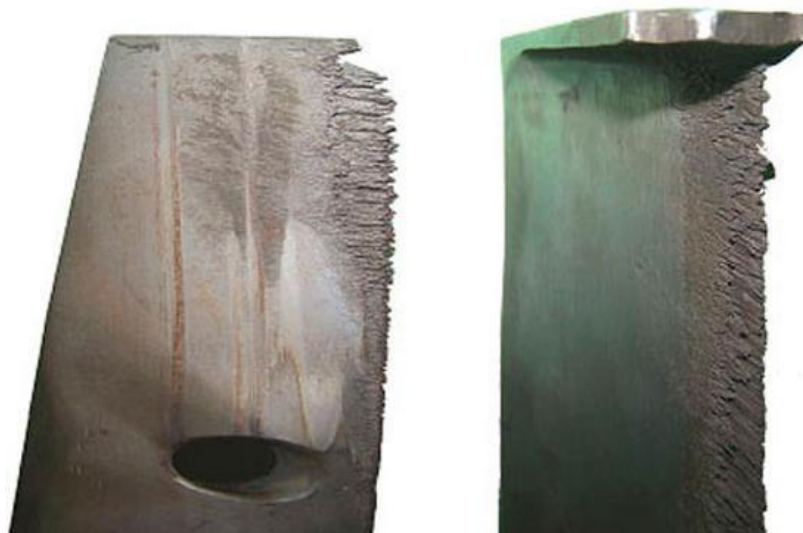
Рис. 1.4 – Эрозионный износ лопаток
