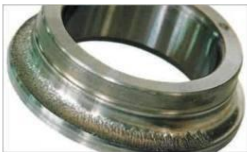
Рис. 1.1 – Контактный износ кольцевой поверхности втулки
